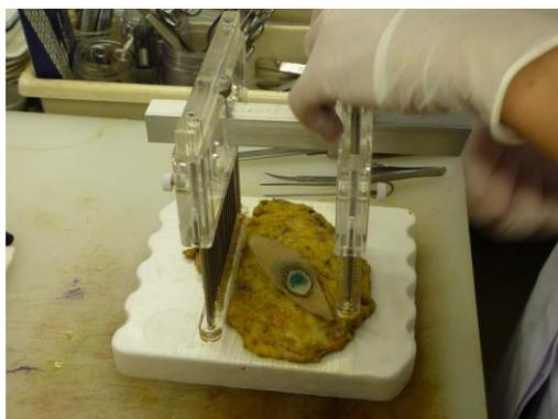
図3 スライスしたい組織に切出し補助器具をセットする。
